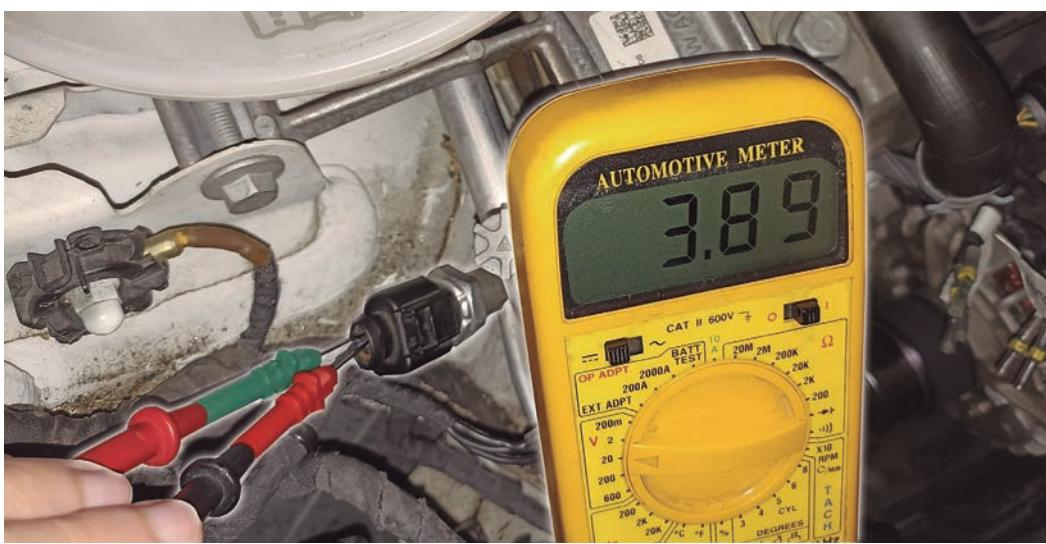
Međutim, ako se ista varijacija mjeri osciloskopom, ljudsko oko često je ne uočava, osim ako se mjeri s vrlo širokom vremenskom bazom, što je neobično pri korištenju ovog alata. Štaviše, u mnogim slučajevima, automobilski osciloskopi imaju nezavisni mjerni ulaz za svaki kanal (liniju signala), što je zajednička referenca za sve dostupne kanale, pa čak i za napajanje uređaja. Razlika izmjerene napona biće tada između ulazne linije signala, spojenog na pozitivno napajanje senzora
