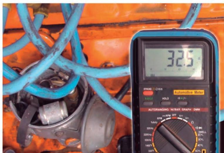
Takođe je vrijedno spomenuti položaje ugla zatvorenosti za određeni broj cilindara. U mnogim slučajevima, podaci o prilagođavanju ugla zatvorenosti za sistem paljenja klasičnih vozila dostupni su samo u ovom formatu, te su stoga savršena funkcija kako se ne bi vršili izračuni pretvaranja.
