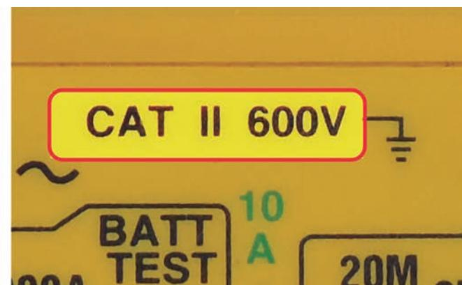
**Električni mjerni uređaji koji se zakonito stavljuju na tržiste moraju imati naznačen maksimalni napon prema kojem električna izolacija opreme sprečava bilo kakvo curenje struje koje može biti opasno za korisnika.** Poznavanje nazivnog radnog napona kruga na kojem se radi i poštivanje dovoljne granice matematičke inferiornosti u odnosu na ove podatke, sigurnost u slučaju pražnjenja ili strujnog udara mora biti dovoljno u normalnim i/ili predvidljivim uslovima.
