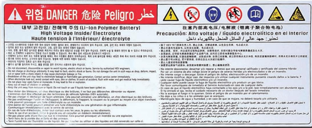
Ipak, zbog tehničkih specifičnosti i radnih napona, hibridni i električni automobili zahtijevaju korištenje alata kategorije III i mjernog napona do 1000V kako bi se provjere mogle obaviti s dovoljnim stepenom sigurnosti. Postojanje generatora i transformatora visokog napona povećava mogućnost prolaznih struja i opasnost od strujnog udara u tim vozilima. Treba napomenuti da radni napon nekih od najsnažnijih modela trenutno doseže 800V.
